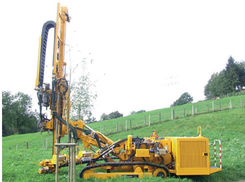
Bild 2. Bohrgerät für eine Erdwärmesonde
